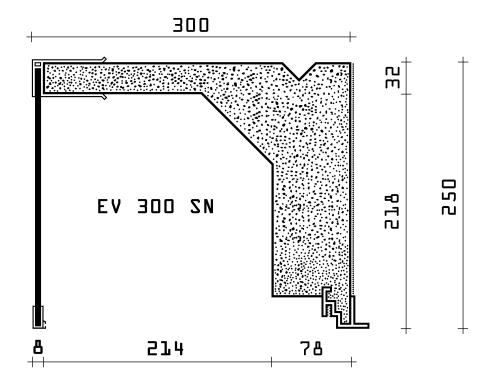
Serienmäßig haben alle Rolladenkästen der Typenreihe EV eine spezielle Clip - Innenschiene für den einfachen, schraublosen EASY - CLIP - Deckelanschluss, mit 15 mm Ausladung, sowie ein U-Profil als unterem Abschluss an der Außenschürze.
